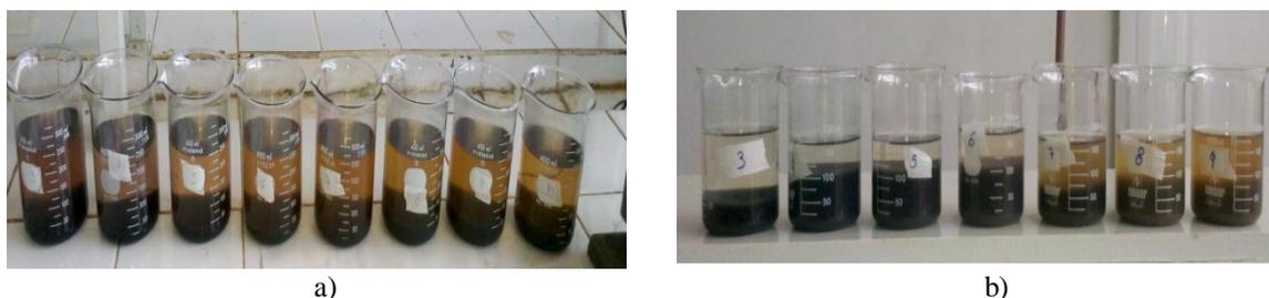
**Figura 4:** Fotos ilustrativas de: a) ensaio do diagrama de coagulação de referência obtido pela coagulação com tanino SL 8% e b) ensaio de diagrama de coagulação obtido pelo uso de tanino conjunto com aluminato de sódio na concentração 5% de tanino e aluminato de sódio 10% na proporção 3:1 (v/v).
