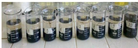
**Figura 5:** Foto ilustrativa do ensaio realizado para o diagrama de referência utilizando tanino SL como único coagulante em concentração 15%.
